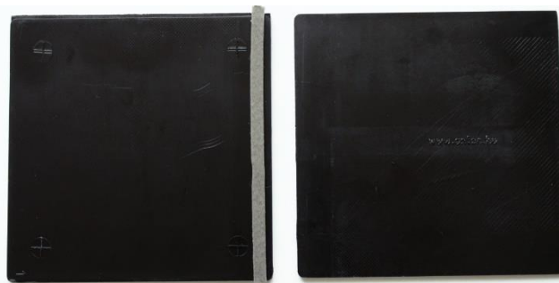
2. ábra Ragasztott kötés tisztán adhíziós tönkremenetele (megjegyzés: az ábrán tönkremenetel után a jobboldali lapka megfordítva látható, így szemléltetve, hogy a ragasztószalag a jobboldali lapkáról teljesen levált)
